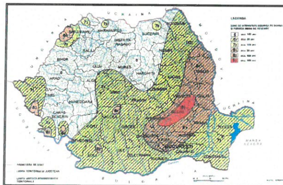
Fig. 6. Zonarea seismică a teritoriului României.
