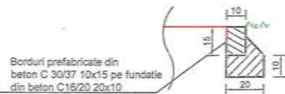
DETALIU B Bordura prefabricata noua 10x15 Scara 1:20
