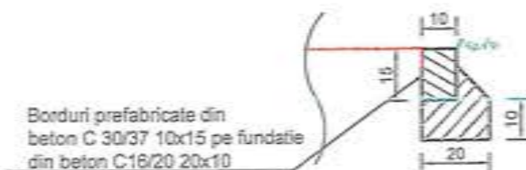
DETALIU B Bordura prefabricata noua 10x15 Scara 1:20
