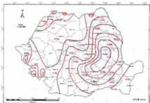
Figura 3.1 România - Zonarea seismică de vârf în cutremurele medii pentru proiectare cu IMR = 225 ani și 20% probabilitate de depășire în 50 de ani
